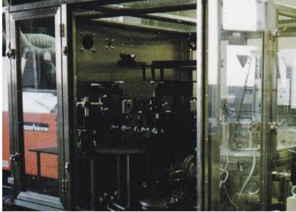
レーザーCVD装置CL-12000は高出力エキシマレーザーを使って、ヒーターの埋め込まれた100mm角の基板ホルダー上に成膜するレーザーCVD装置です。基板は、X-Yに連動して動かすことができます。
